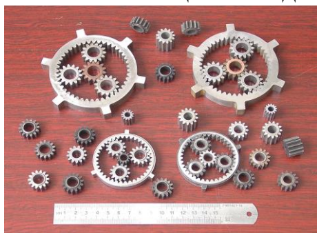
Детали планетарного редуктора автомобильного стартера
